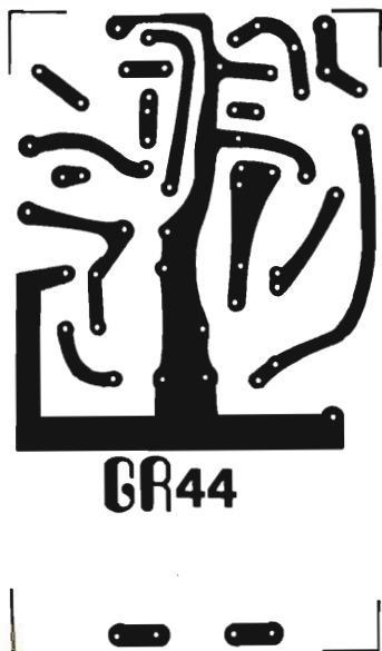
Fig. 5 - Designo del circuito stampato in grandezza naturale che il lettore dovrà riprodurre per la realizzazione del dispositivo rivelatore di gas presentato e descritto in questo articolo.
